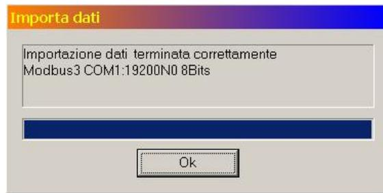
Premendo il tasto OK si potrà vedere nel box 'Configurazione comunicazione seriale EVOSEK' che i dati memorizzati nello strumento coincidono con quelli che ci eravamo prefissati di memorizzare.
