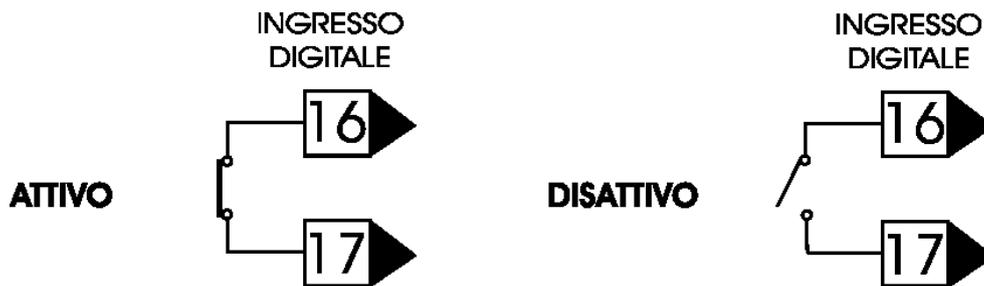
**ATTENZIONE:** l'ingresso digitale è optoisolato. **NON** collegare nessuna tensione a questi morsetti: tale operazione potrebbe provocare la rottura dello strumento. Ai morsetti 16 e 17 collegare solamente un contatto libero da potenziale (esempio switch meccanico, contatto di un relè ecc..). Per le funzionalità associate a tale ingresso fare riferimento al parametro SLA nel menù livello3
