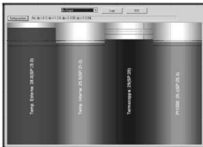
Tale visualizzazione è molto utile quando l'operatore vuole tenere sotto controllo in maniera semplice e veloce lo stato di più zone. Ogni barra, rappresenta graficamente il valore di processo di ogni singolo strumento presente nella rete di comunicazione.
