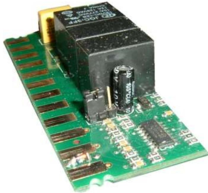
**ATTENZIONE:** Lo strumento viene fornito con il jumper impostato su **Pt100**
