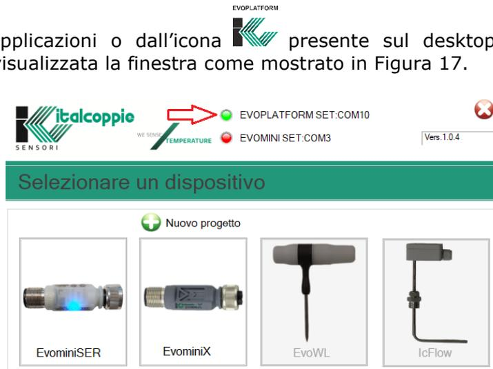
Figura 17: selezione del dispositivo connesso
